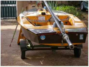
Construction AVIATEC polyester coque et pont :
